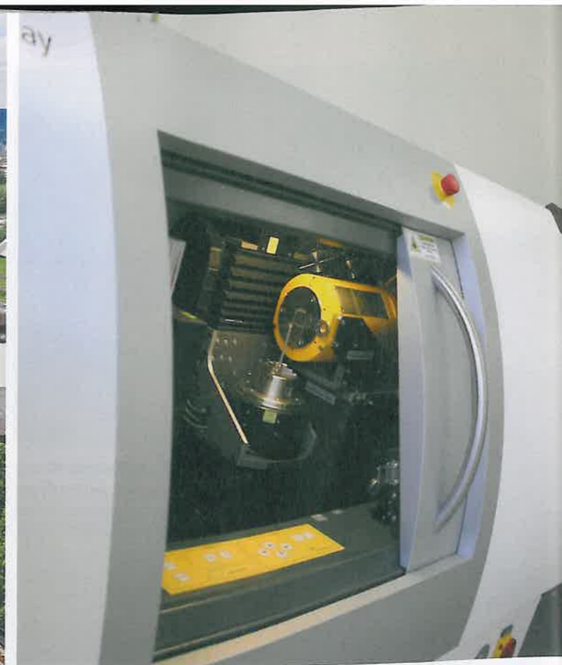
Nanotom: Werkstoffe werden ohne Zerstörung geprüft.
