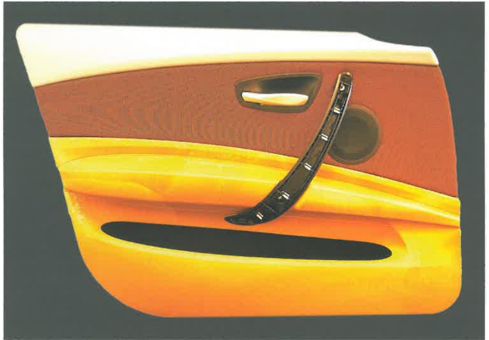
Autotür-Innenverkleidung aus Wood Plastic Composites (WPC)
